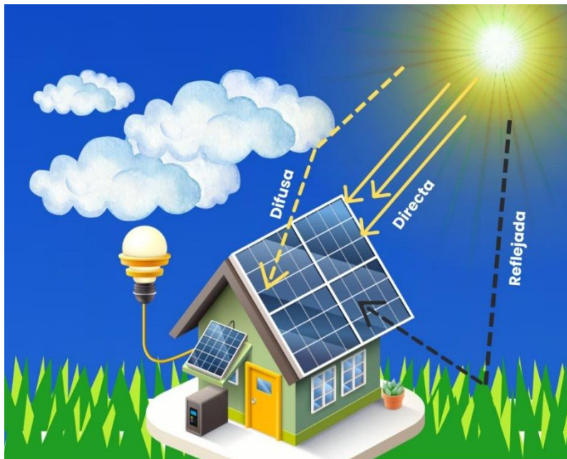
Figura 2.1. Componentes de la irradiación solar: directa (rayos solares sin dispersión), difusa (radiación desviada por la atmósfera) y reflejada (fracción de la radiación reemitida por la superficie terrestre).
