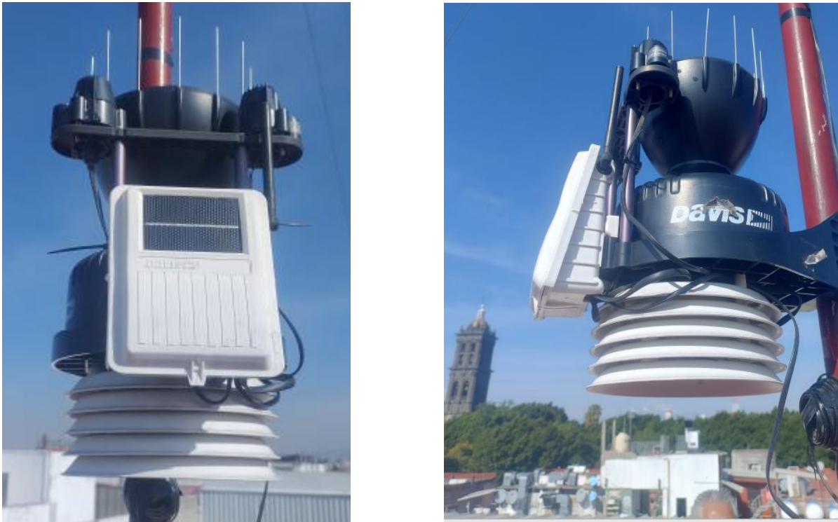
Figura 4.11 Estación meteorológica Davis instalada en el área del Carolino.
