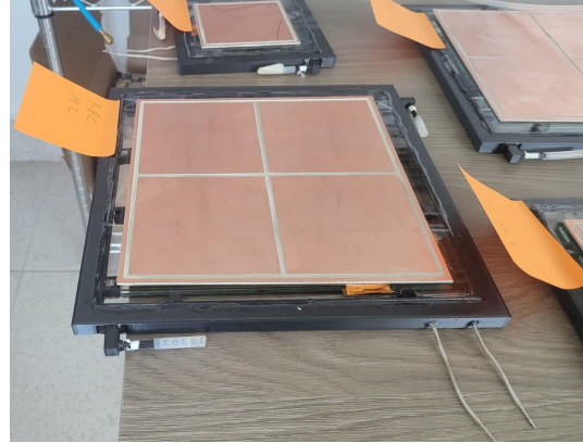
(b) Detector RPC de doble gap completamente ensamblado, sellado y listo para las pruebas.
