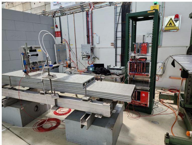
Figura 6.2: Fotografía del arreglo experimental instalado en la zona T10 del CERN. Se muestran los dos detectores RPC montados en la línea de haz y alineados con el resto de la instrumentación para las pruebas de rendimiento.
