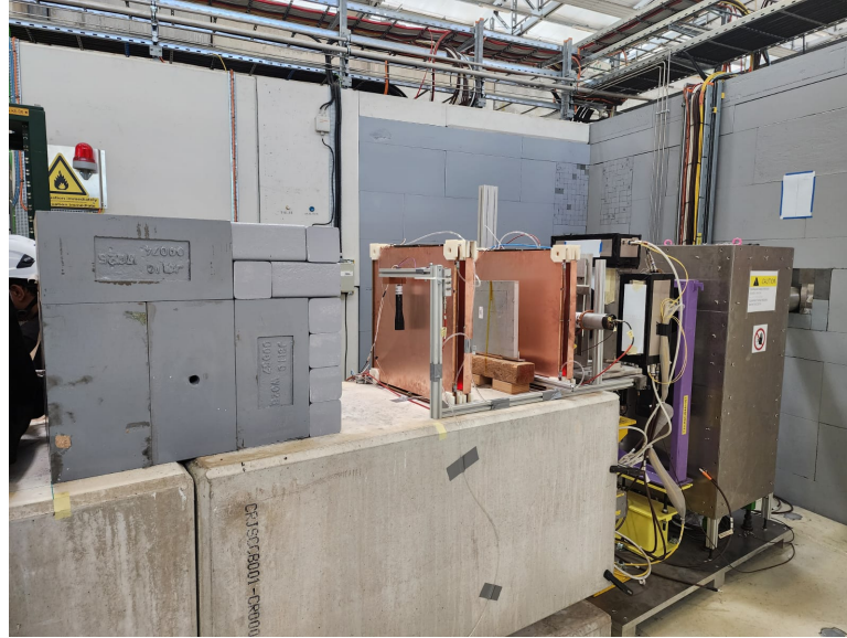
Figura 6.5: Fotografía del montaje experimental en la línea de haz T10 durante la campaña 2024. En primer plano se observa uno de los prototipos RPC instalado en la trayectoria del haz, seguido inmediatamente por el bloque absorbedor de acero. Esta configuración permite medir la eficiencia del detector antes y después de la interacción del haz con el material denso.
