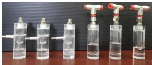
(c) Estado final de la construcción del sistema de burbujeador.
