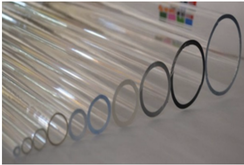
(a) Tubos de acrílico utilizados para construir el sistema de burbujeo.
