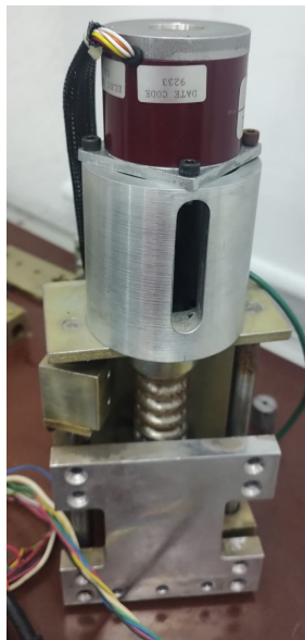
Fig 3.15: Ensamble del movimiento en el eje Z
