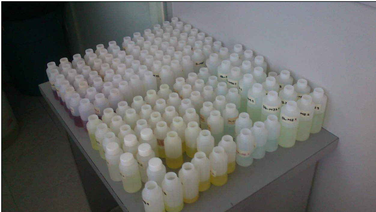
Imagen 4. Preparación de las muestras para análisis por Absorción Atómica.
