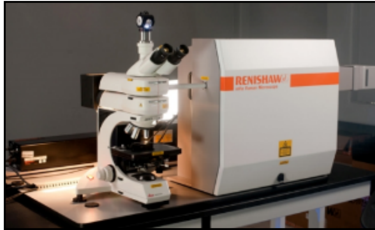
FIGURA 2. 19 Equipo utilizado para el análisis de espectroscopia Raman espectrómetro micro Raman de Renishaw.
