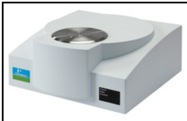
FIGURA 2.20 Equipo utilizado para el análisis termogravimétrico en un STA 4000 Perkin-Elmer.
