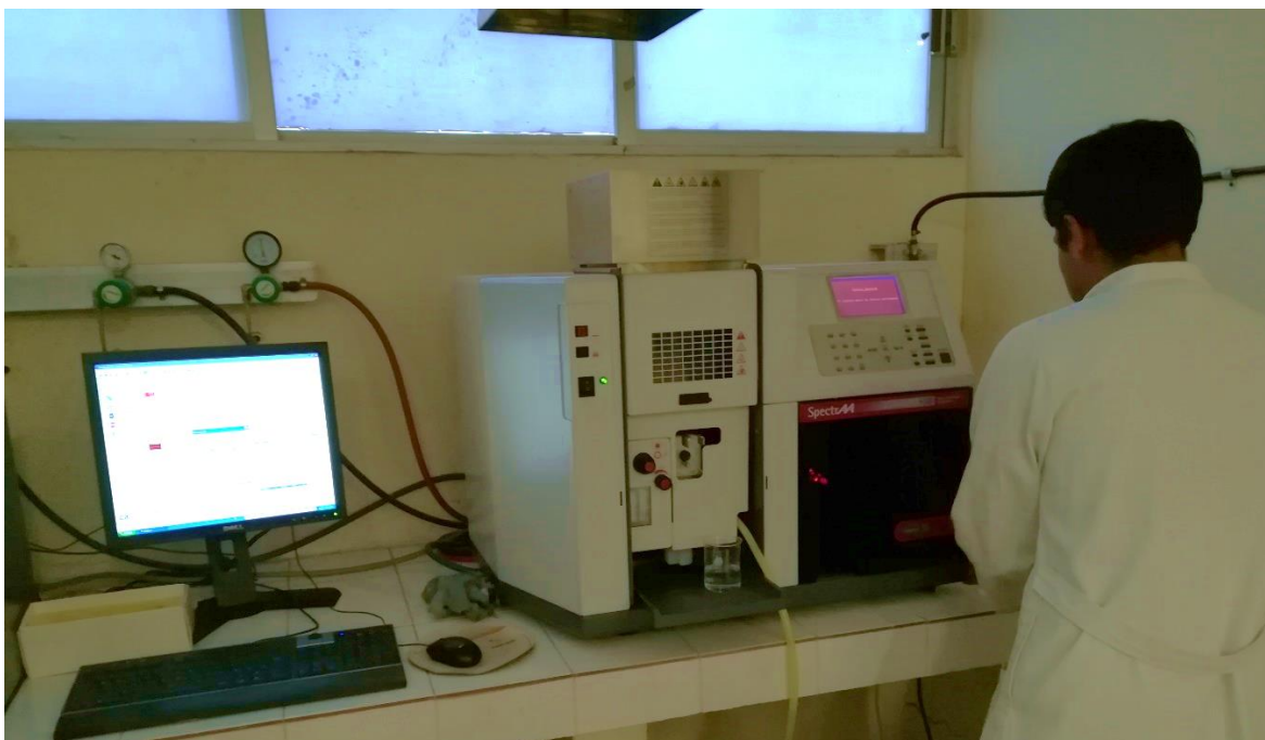
Figura 24. Determinación de metales pesados mediante Espectrometría de Absorción Atómica. Fuente: Elaboración propia, 2020.
