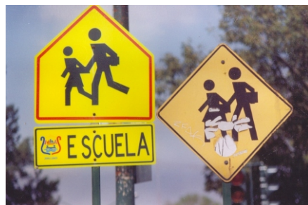
Figura 10. El cambio de color, de pictografía, así como del formato en la señal que ya está definida en la norma de la S.C.T federal, solo hace que el peatón y conductor se confundan.
