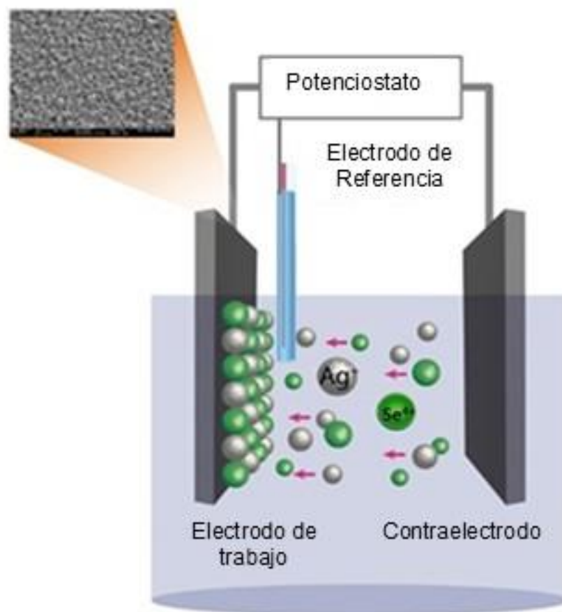
Figura 4.4 Diagrama esquemático de la celda electroquímica utilizada para estudios voltamperométricos y depósito de películas delgadas de \text{Ag}_2\text{Se} . El diagrama ilustra el mecanismo de formación durante el proceso de depósito electroquímico. El inserto superior muestra una imagen representativa de la película depositada. [2]
