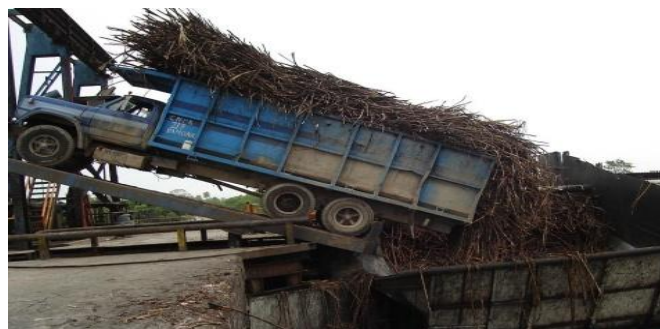
Figura 18. Descarga de caña por medio de un volteador hidráulico Fuente: Archivo fotográfico ISRP, 2007
