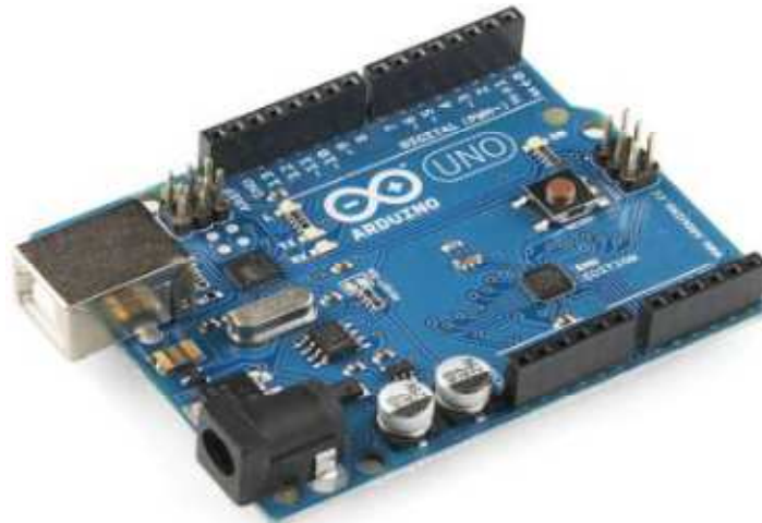
Figura 6.11. Arduino UNO con microcontrolador en formato SMD.
