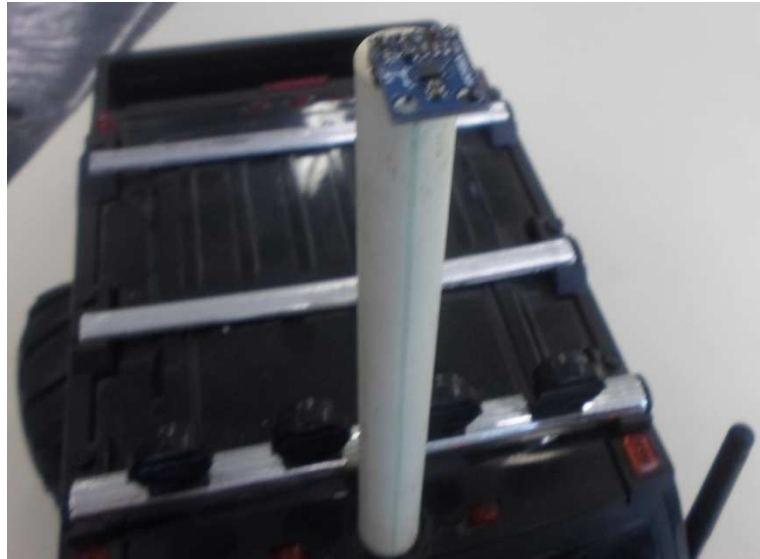
Figura 6.18. La brújula electrónica HMC5883L implementada en el robot móvil HUMMER H2.
