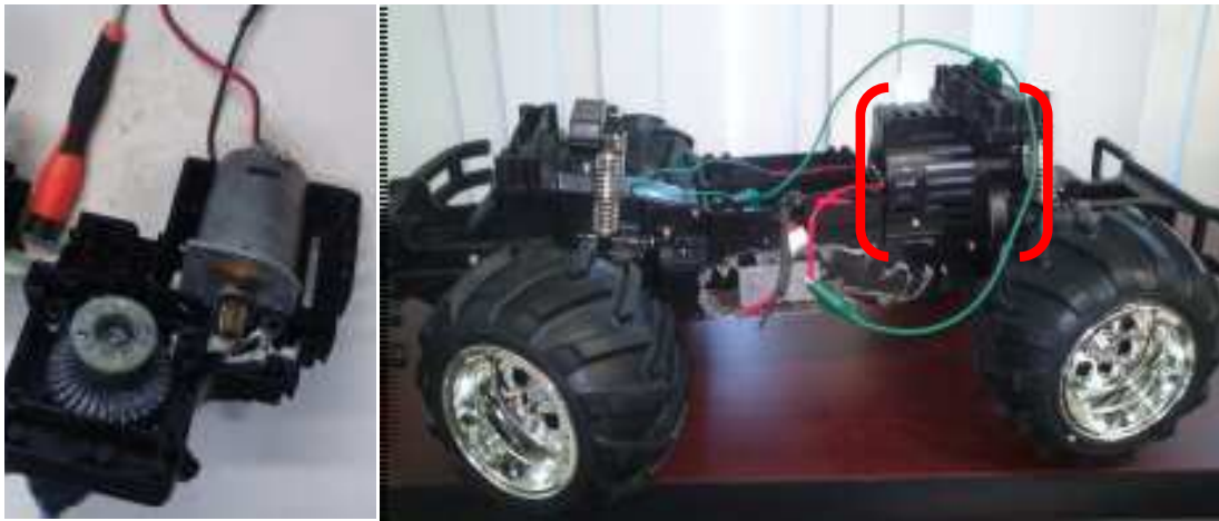
Figura 3.11. Motor de tracción del robot móvil HUMMER H2.
