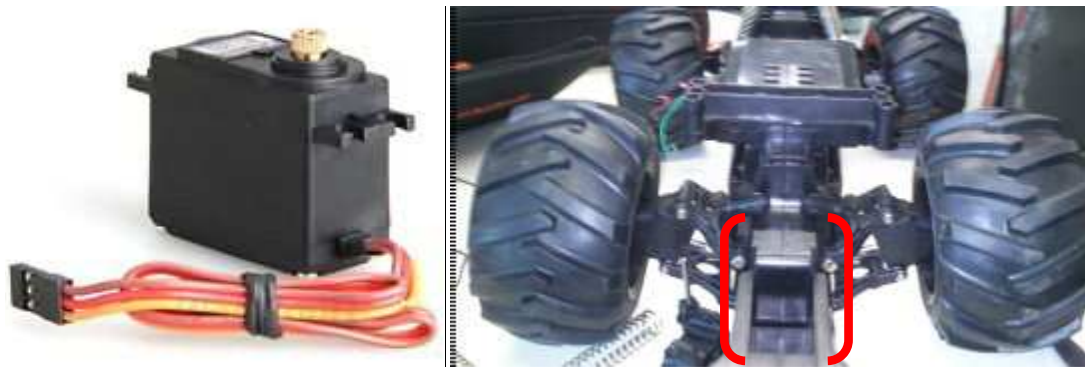
Figura 3.10. Servomotor de dirección del robot móvil HUMMER H2.
