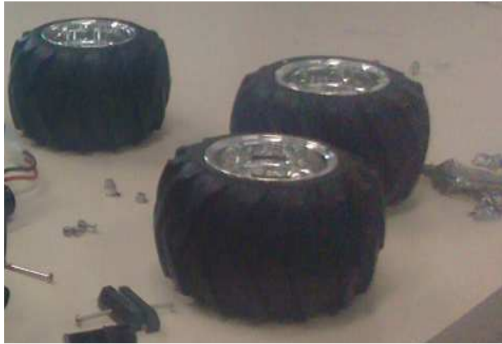
Figura 3.8. Llantas tipo estándar del robot móvil HUMMER H2.
