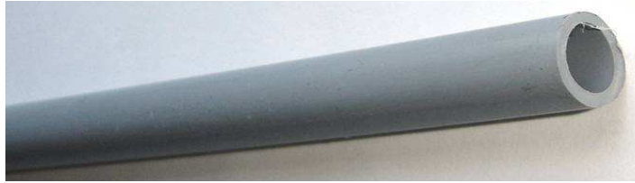
Figura 3.16. Aislador de campo magnético del magnetómetro.
