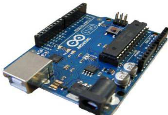
Figura 6.10. Arduino UNO con microcontrolador en formato DIP.
