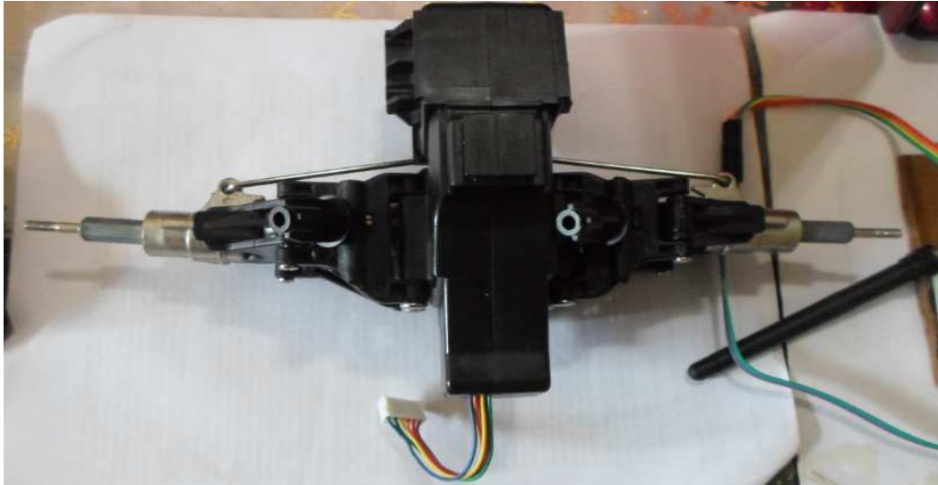
Figura 3.14. Potenciómetro utilizado como sensor de la dirección del robot móvil HUMMER H2.
