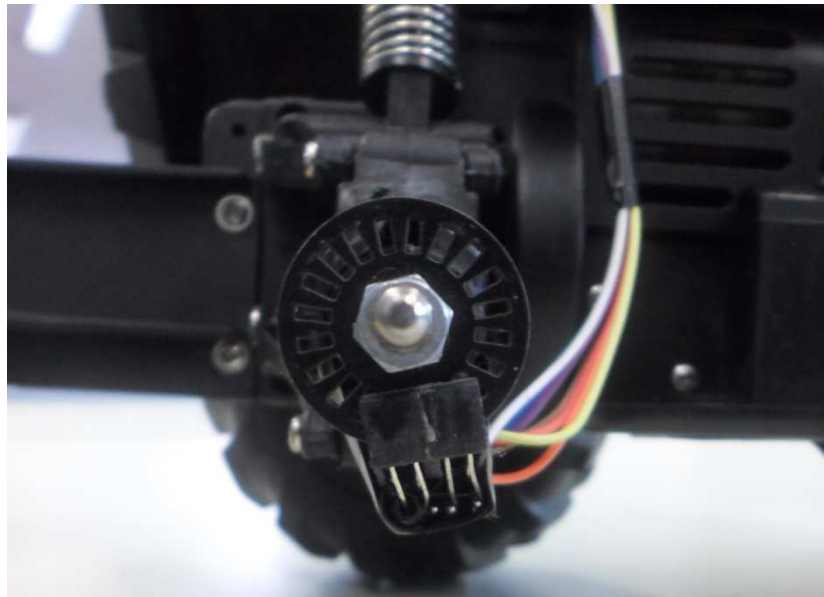
Figura 3.12. Encoder utilizado como sensor de la posición del robot móvil HUMMER H2.
