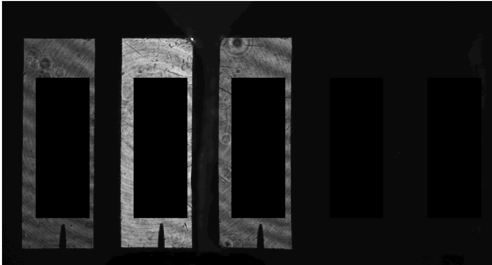
Figura 4.20: Área que se recorta de los interferogramas. Se muestra la ventana de referencia, pero esta área se recorta en las tres imágenes
