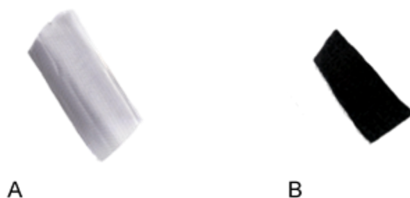
Figura 22. Materiales de electrodo empleados en los experimentos de electrólisis. Malla de Pt (A) y fieltro de carbón (B)
