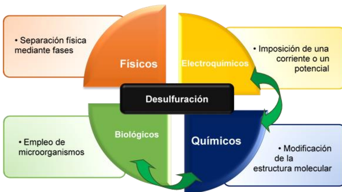
Figura 3. Clasificación de metodologías de desulfuración de hidrocarburos. Adaptado de la referencia [21].
