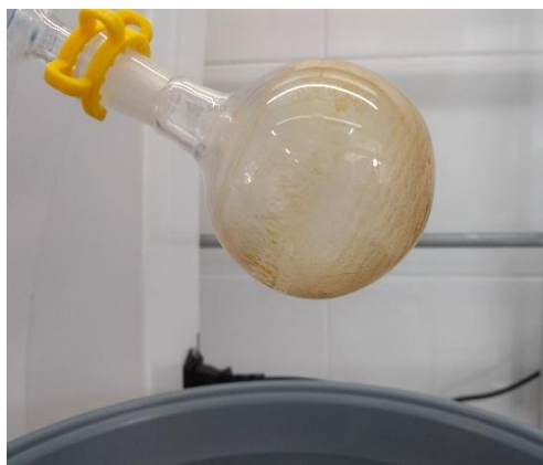
Figura 55. Remanentes sólidos obtenidos a partir de la primera destilación.
