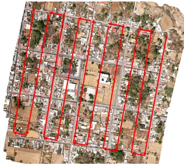
Trayectoria de vuelos realizados para la generación de ortofotografía y mallas tridimensionales por manzana. Autoría propia
