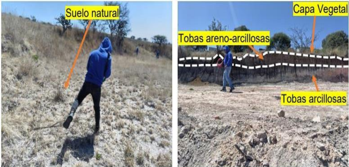
Fotografías de la zona de estudio que muestran los materiales geológicos característicos de la zona de estudio.
