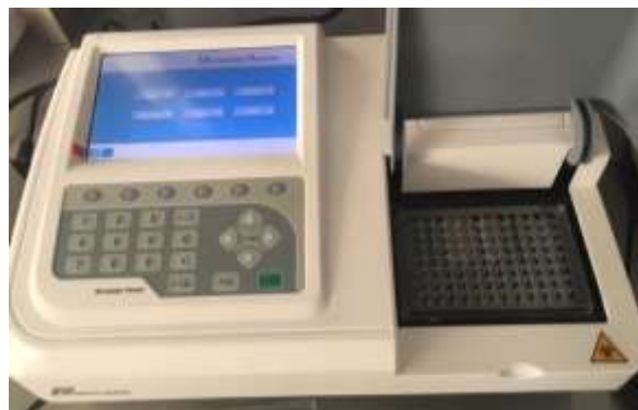
Figura 26. Lector de microplacas POWEAM WHYM201
