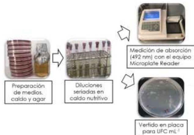
Figura 16. Diagrama de flujo del ensayo microbiológico (elaboración propia)
