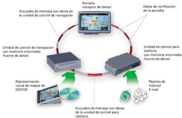
Figura 2.4 Red MOST de imagen y sonido en Audi [20]
