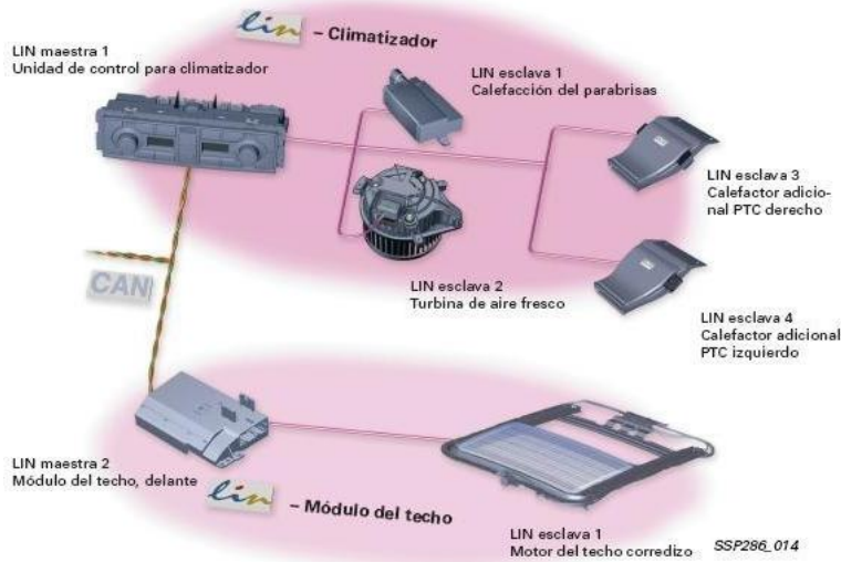
Figura 2.3 Protocolo LIN-Bus y su integración al CAN Bus [20].
