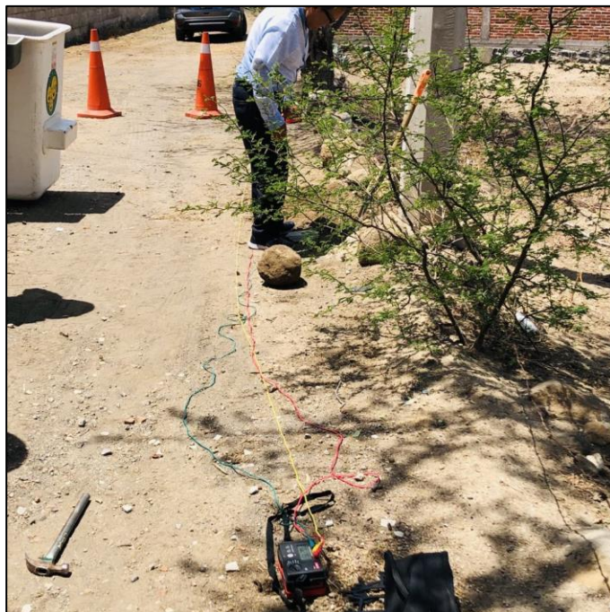
Figura 36. Conexión de probador Digital UNI-T UT522.
