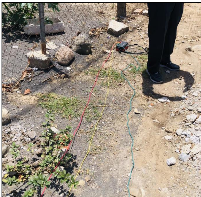
Figura 41. Conexión de probador Digital UNI-T UT522.
