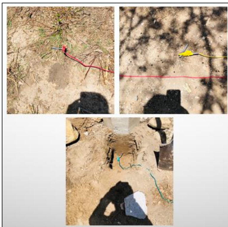
Figura 37. Conexión de los 3 cables probador Digital UNI-T UT522.
