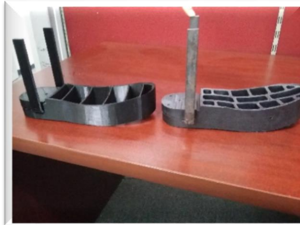
Ilustración 20 Plataforma impresa en 3D / Plataforma realizada con Nylamid
