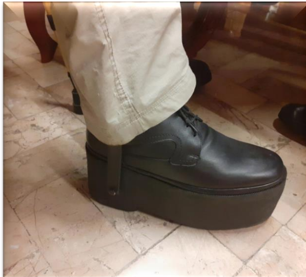
Ilustración 25 Zapato 3 en uso con suela Nylamid SL
