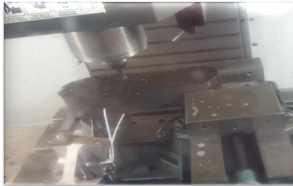
Ilustración 19 Maquinado de la suela.
