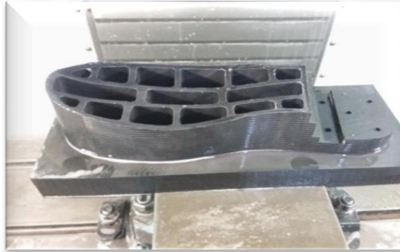
Ilustración 18 Vaciado de la plataforma y barrenos del tacón.
