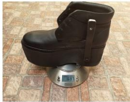
Fig. 16 Zapato 3 / Nylamid SL/ con un peso de 1.697 Kg.
