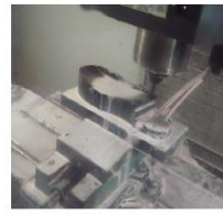
Fig. 11 Maquinado de la parte cóncava de la plataforma
