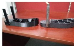
Fig. 13 Plataforma impresa en 3D / Plataforma maquinada
