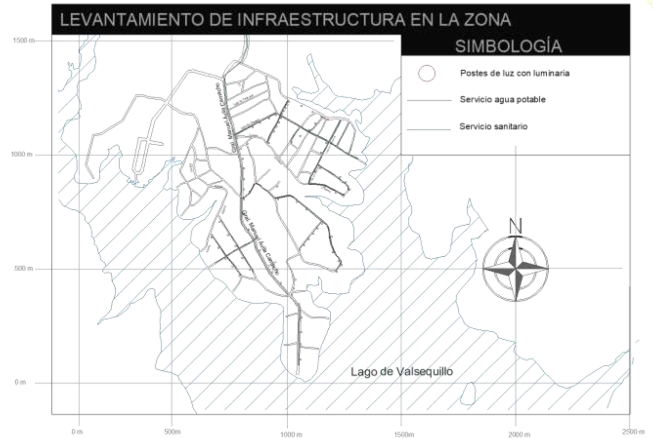
Figura 2.9.1 Plano ilustrativo de la infraestructura en la zona Oasis. Fuente: Elaboración propia
