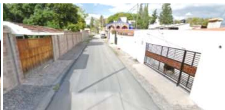
Figura 2.11.5.2 Fotografía del sitio. Avenida Gral. Manuel Ávila Camacho con banquetas a nivel de suelo y 70 cm de ancho. Fuente: Google Maps
