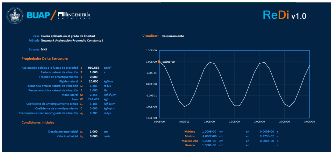
Figura 4.1.4. Desplazamiento por el Método de Newmark Aceleración Promedio Constante. (Autoría propia, 2020).
