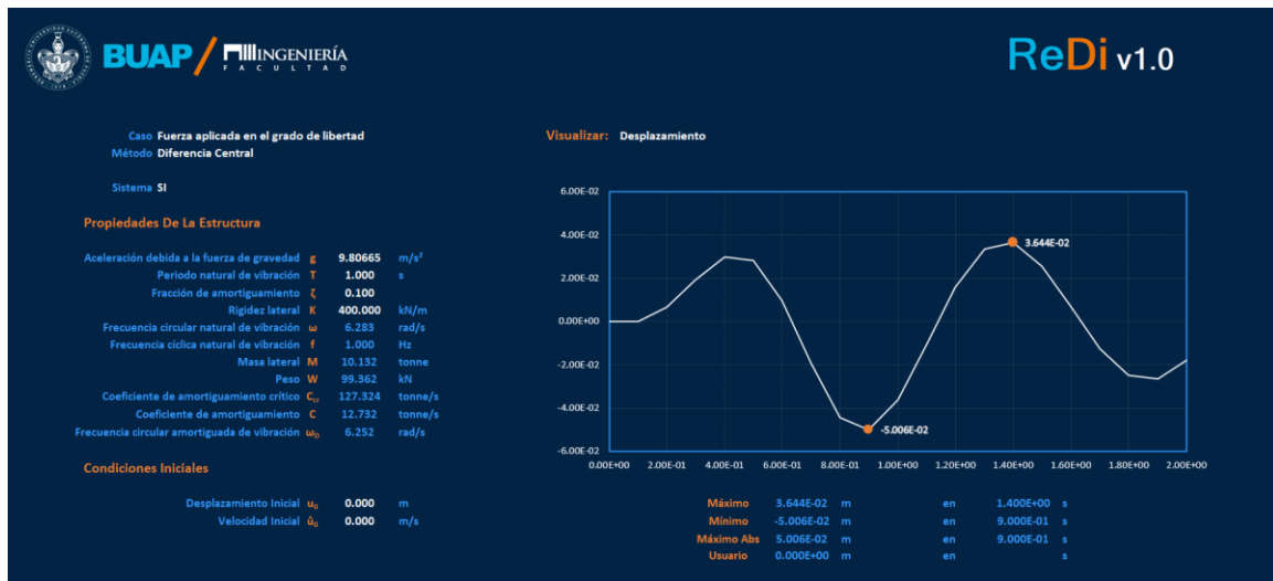
Figura 3.2.4. Desplazamiento por el Método de Diferencia Central. (Autoría propia, 2020).
