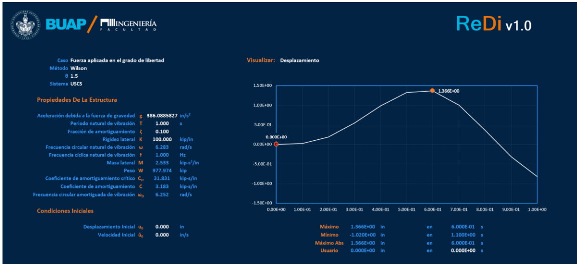
Figura 4.1.18. Desplazamiento por el Método de Wilson con \theta = 1.5 . (Autoría propia, 2020).
