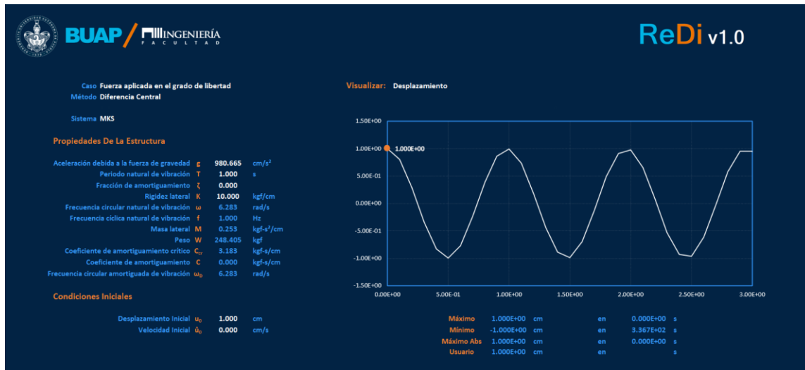
Figura 4.1.3. Desplazamiento por el Método de Diferencia Central. (Autoría propia, 2020).
