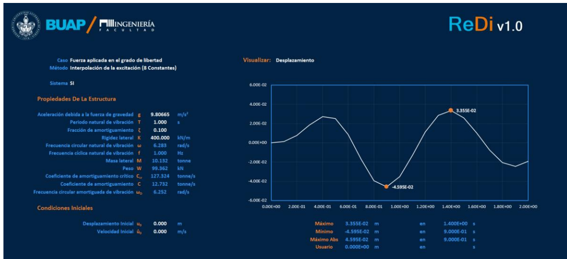
Figura 3.2.3. Desplazamiento por el Método de Interpolación de la Excitación. (Autoría propia, 2020).
