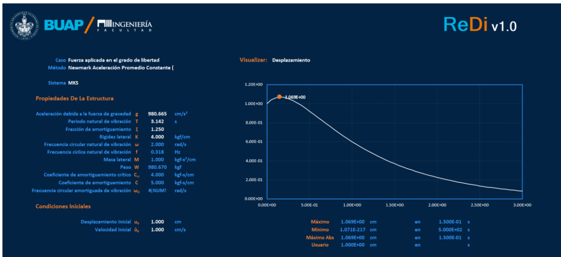
Figura 4.3.4. Desplazamiento por el Método de Newmark Aceleración Promedio Constante. (Autoría propia, 2020).
