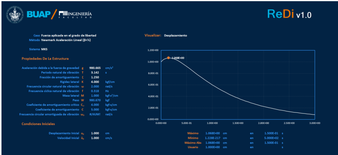
Figura 4.3.5. Desplazamiento por el Método de Newmark Aceleración Lineal. (Autoría propia, 2020).
