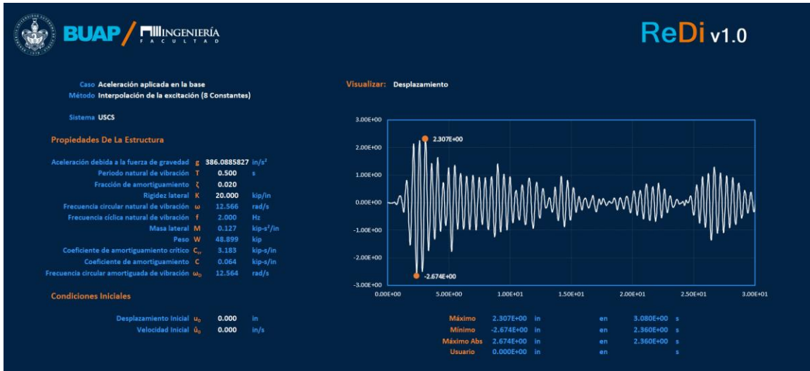
Figura 3.2.9. Desplazamiento por el Método de Interpolación de la Excitación. (Autoría propia, 2020).
