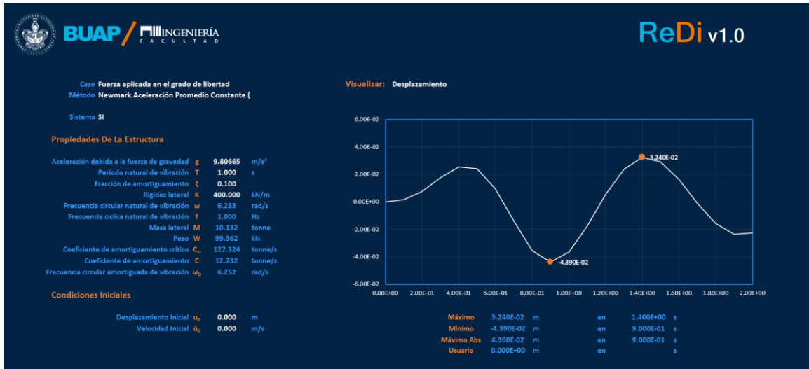
Figura 3.2.5. Desplazamiento por el Método de Newmark Aceleración Promedio Constante. (Autoría propia, 2020).
