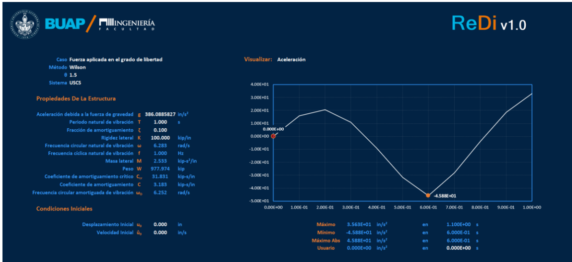
Figura 4.1.20. Aceleración por el Método de Wilson con \theta = 1.5 . (Autoría propia, 2020).
