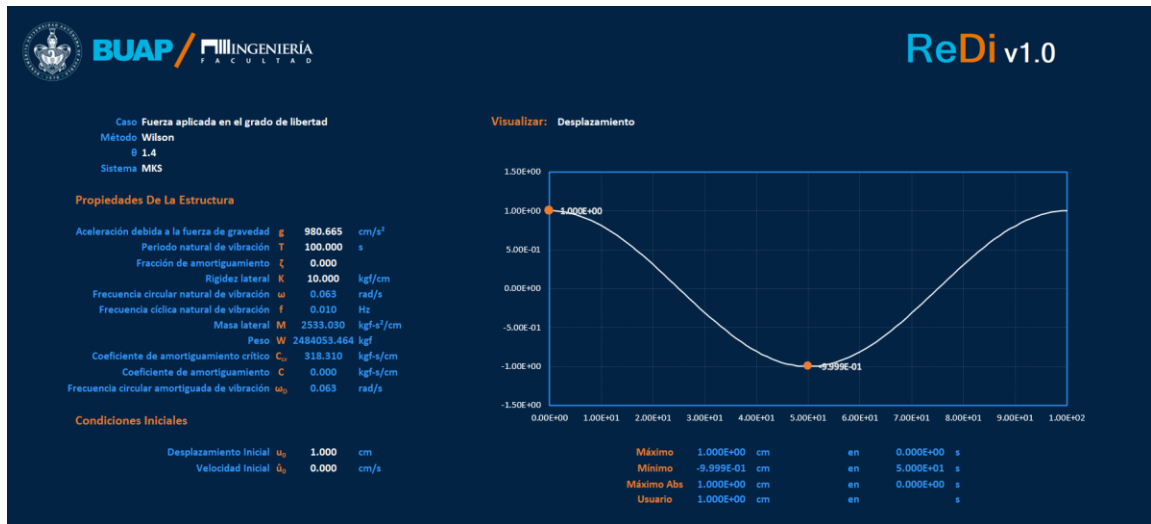
Figura 4.1.11. Desplazamiento para vibración libre con \Delta t/T_n = 0.01 mediante el método de Wilson. (Autoría propia, 2020).
