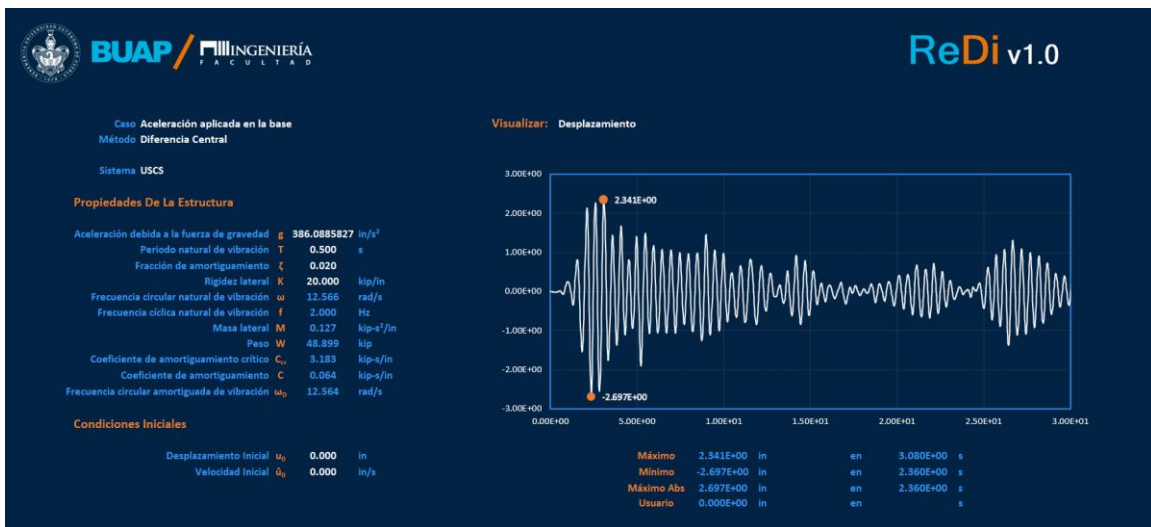
Figura 3.2.10. Desplazamiento por el Método de Diferencia Central. (Autoría propia, 2020).
