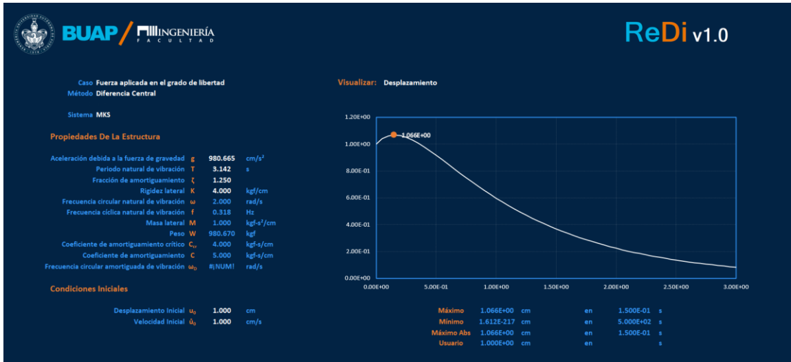
Figura 4.3.3. Desplazamiento por el Método de Diferencia Central. (Autoría propia, 2020).
