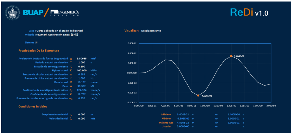
Figura 3.2.6. Desplazamiento por el Método de Newmark Aceleración Lineal. (Autoría propia, 2020).
