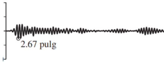
Figura 4.2.3. Comparación de Desplazamiento con T_n = 0.5s y \zeta = 0.02 . (Autoría propia, 2020).
