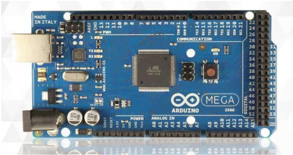
Figura 21. Placa Arduino Mega 2560 (Corapi et al., 2021).
