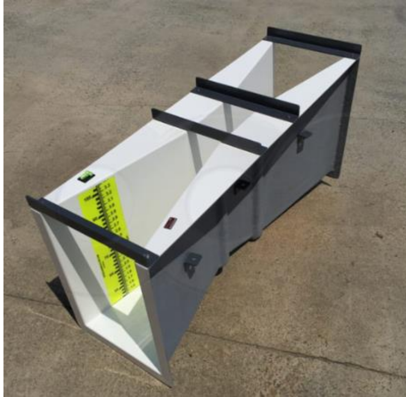
Figura 3. Estructura de canal Parshall, desinstalada (Heyrani et al. 2022).
