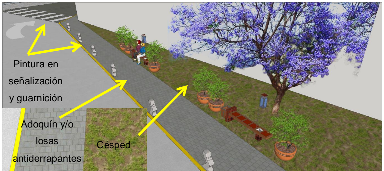
Imagen 82. Materiales constructivos en aceras y camellones
