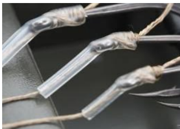
1.16 Imagen Tubo termo contráctil aplicado
