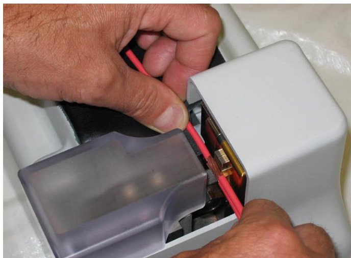
1.15 Imagen Soldadura de cables de cobre por ultrasonido (Soldadura US)
