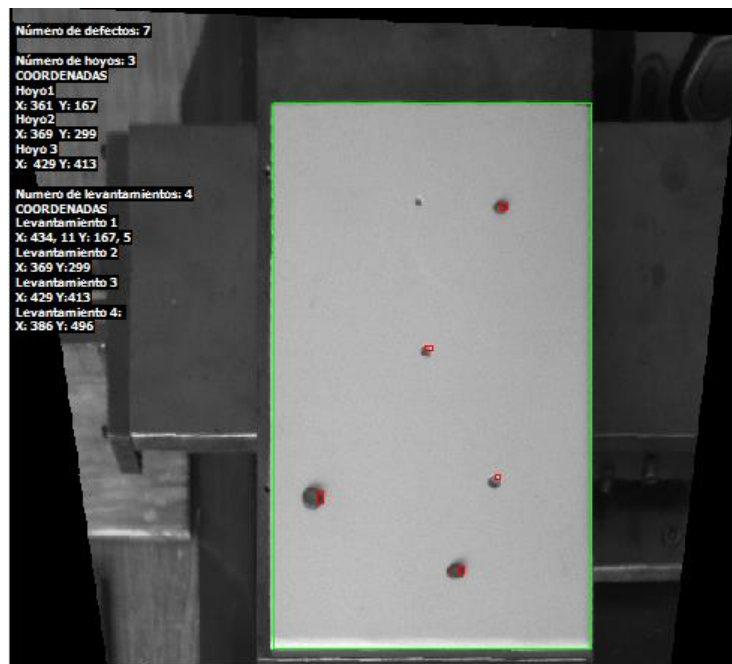
Figura 4.3 Defectos de la Losa 1
