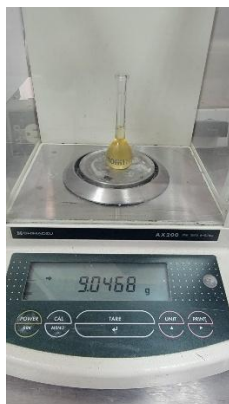
Figura 20. Balanza pesando 10 ml de aceite
