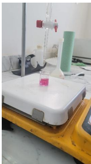
Figura 22. Prueba para determinar el índice de acidez
