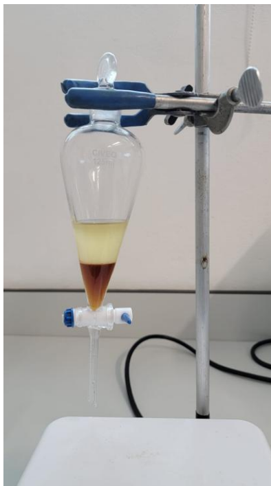
Figura 26. Embudo de separación, biodiésel y glicerina
