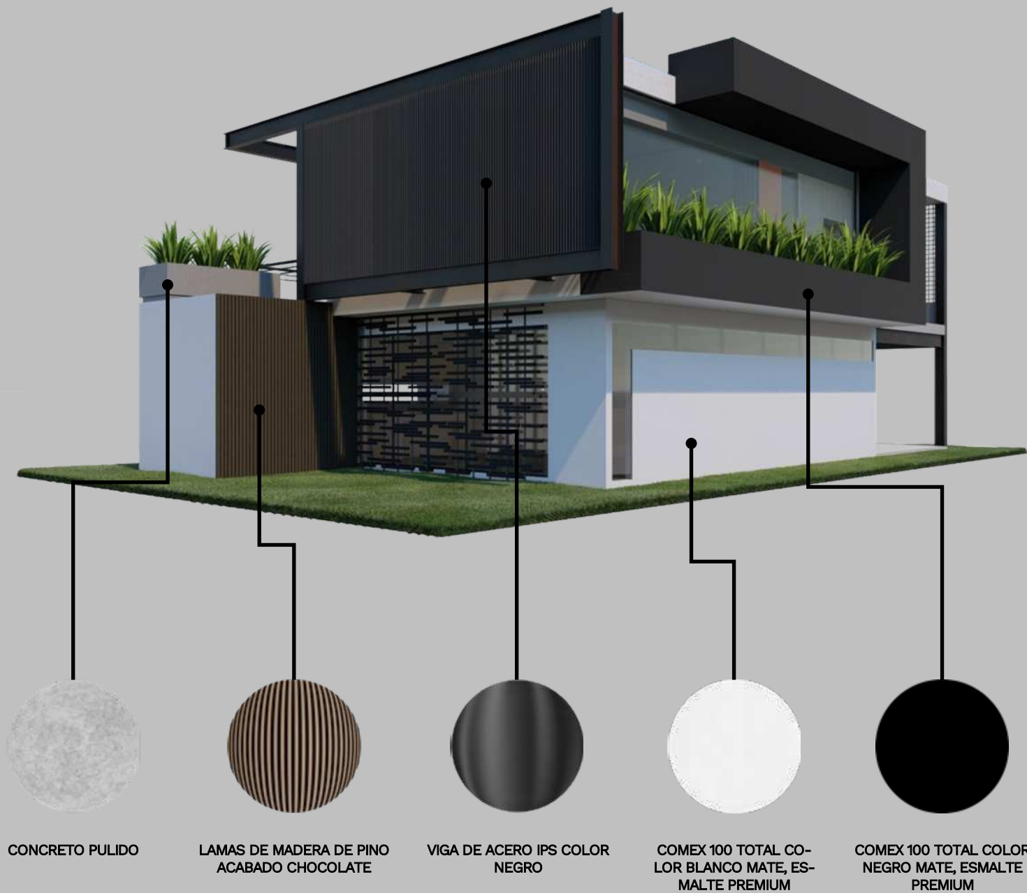
FIGURA 72. Vivienda Flexible, Materiales. Perspectiva Suroeste.
