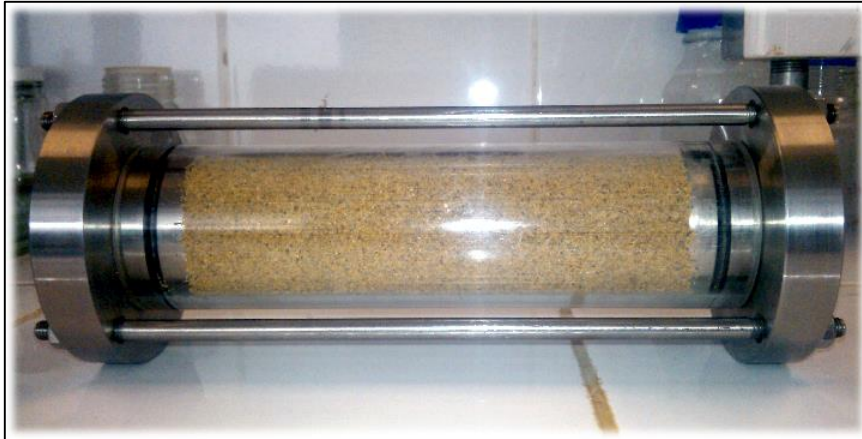
Figura 2.3 Celda experimental empleada durante las pruebas, simulando nuestro medio poroso.
