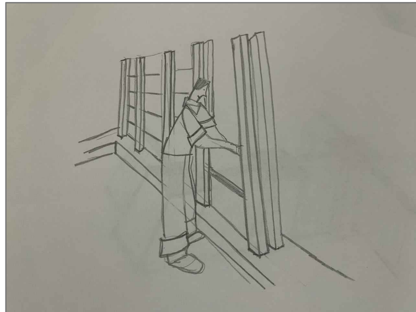
EL SISTEMA CONSISTE EN UNA SOLUCIÓN CONSTRUCTIVA DE ELEMENTOS LIGEROS BASADOS EN COLUMNAS DE HORMIGÓN ARMADO Y PANELES DE HORMIGÓN SIMPLE.
