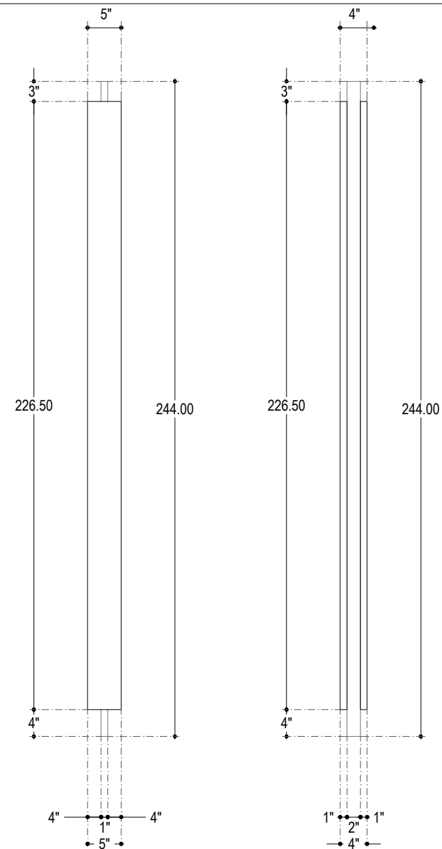
SEPARADOR: VISTA EN ALZADO COTAS: CENTÍMETROS ESCALA: 1:20
