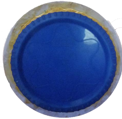
Figura 19. Tapa trasera del prototipo ROV.
