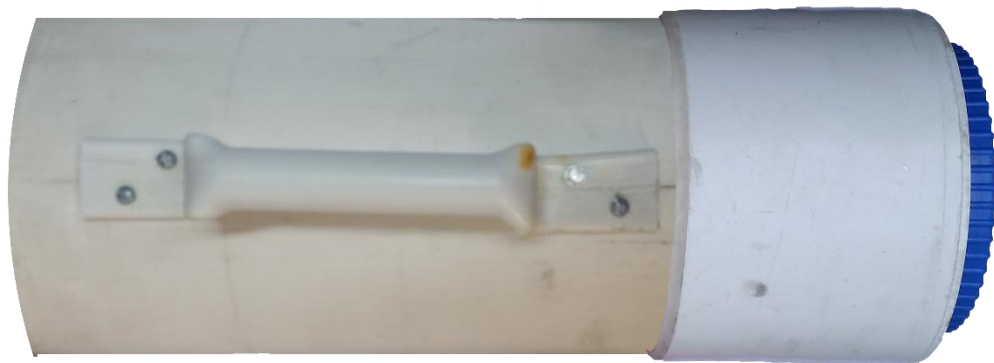
Figura 20. Casco del prototipo ROV.
