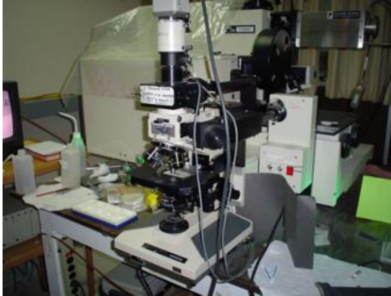
Fotografía 2.12 Espectrómetro Raman utilizado en la medición de vibraciones de red de las capas de GaSb
