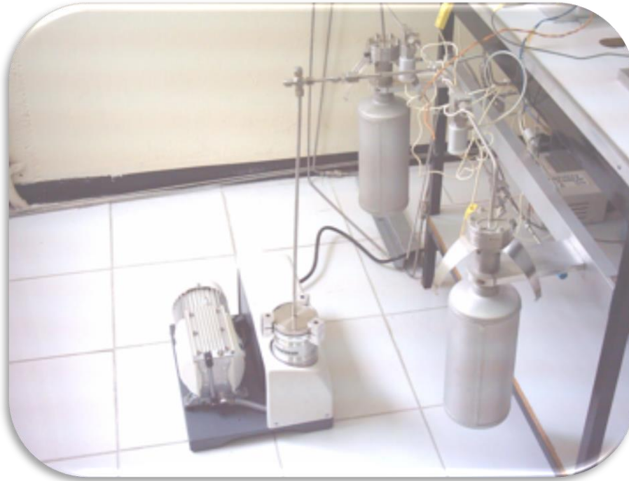
Fotografía 2.7.- Bombas criogénicas de vacío y Bomba turbo molecular seca para el sistema de EFL Maestría en Dispositivos Semiconductores del ICUAP
