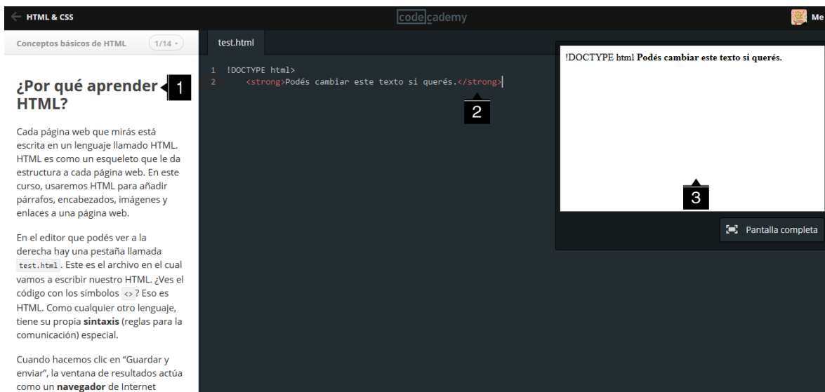
Figura 2.20 En la figura se presenta el mecanismo de interacción entre un usuario y el sistema. A izquierda se localizan las instrucciones que el usuario deberá seguir para dar solución a los retos planteados (1). Al centro se localiza un editor de texto que irá orientando al usuario mientras este vaya codificando (2). A la derecha de la pantalla de muestra la consola de salida del sistema (3) donde se verán reflejados los resultados del código fuente una vez que este ha sido interpretado.
