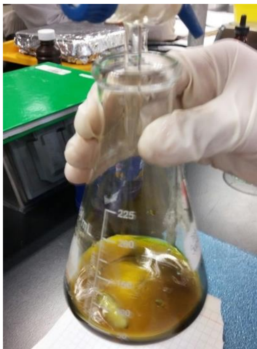
Figura 40. Titulación para la determinación de materia orgánica.
