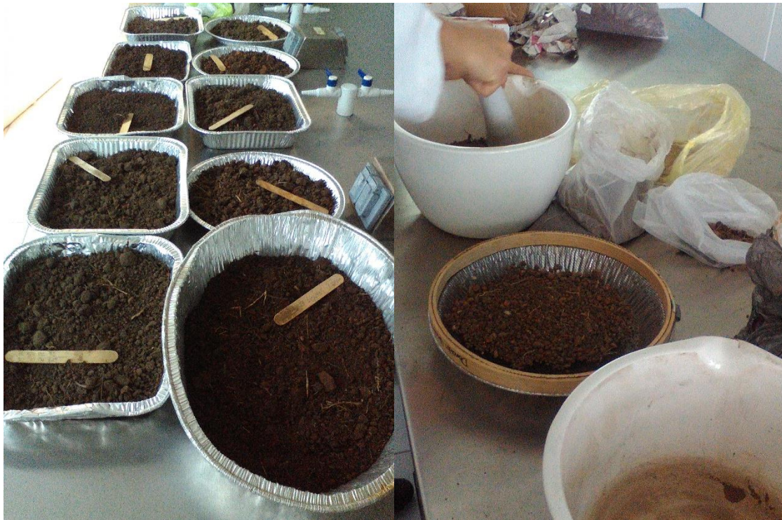
Figura 22. Preparación de muestras. Secado y molienda.
