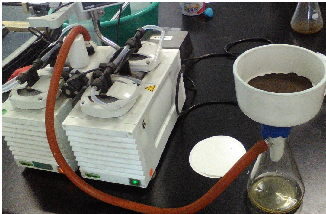
Figura 32. Sistema de vacío para la recolección del extracto de saturación.
