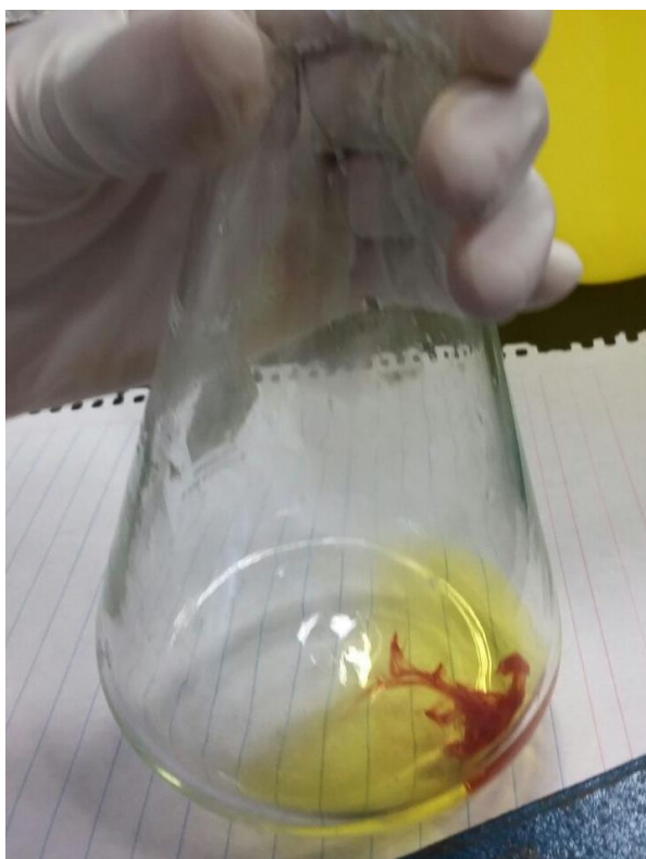
Figura 36. Vire de color para la determinación de cloruros.
