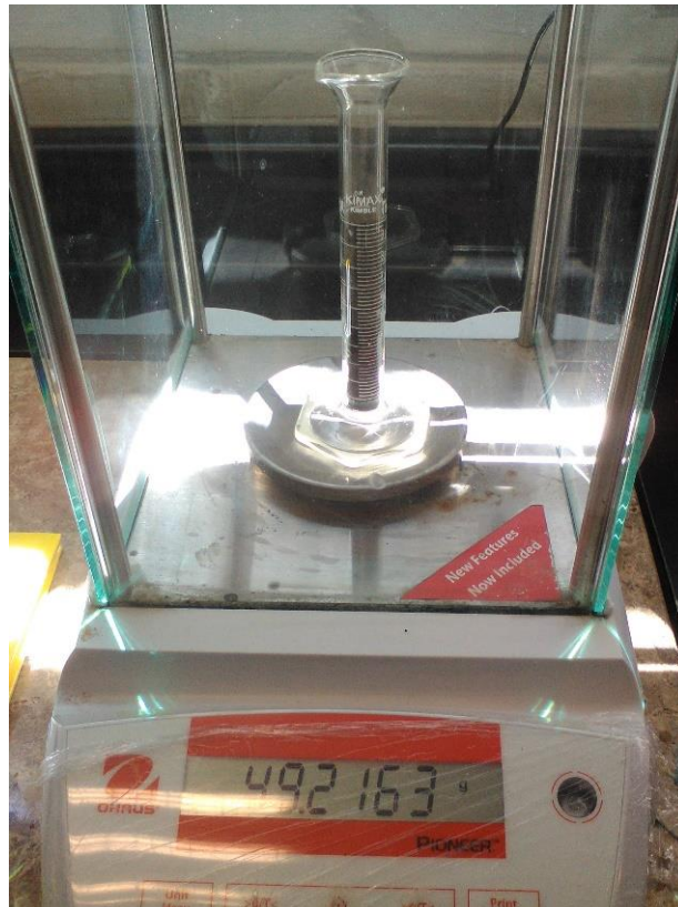
Figura 28. Determinación de densidad aparente mediante el método de la probeta.
