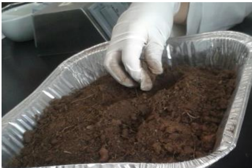
Figura 25. Preparación de la muestra para someterla a secado en estufa.
