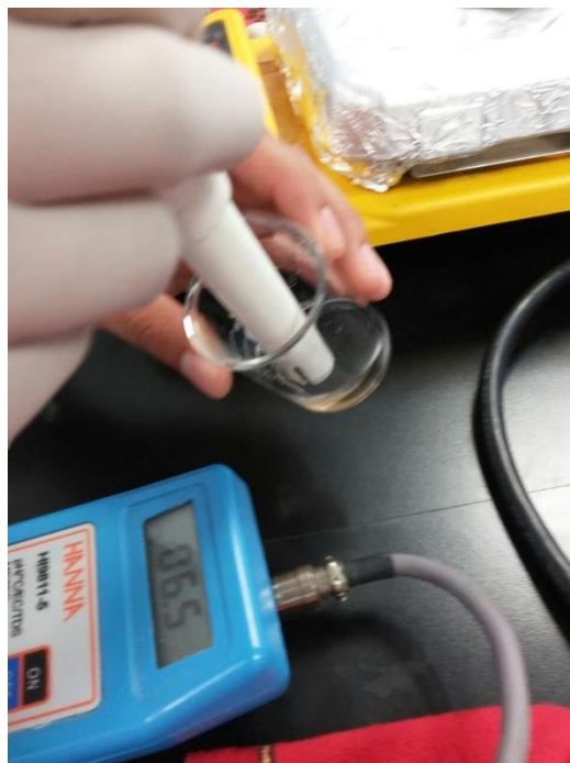
Figura 33. Medición de pH por método potenciométrico.
