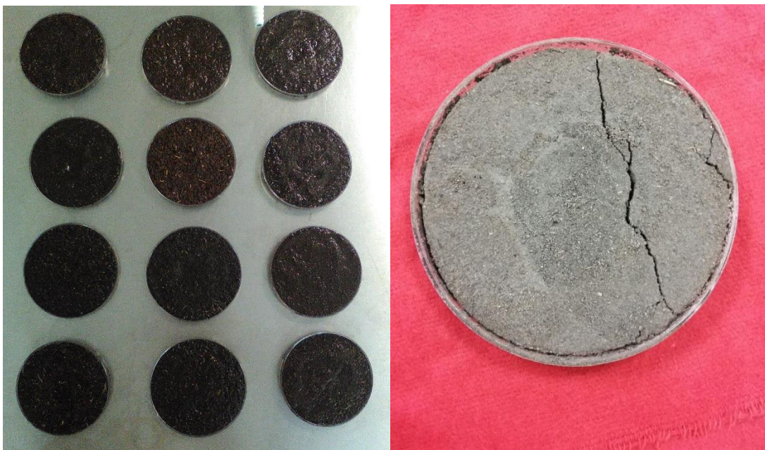
Figura 30. A la izquierda se muestra un lote de muestras húmedas y a la derecha se aprecia una de las muestras después del secado.
