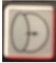
Imagen 45 Comando de cierre de puerta. (CV)
