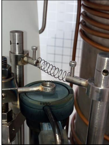
Figura 3.4.- Imagen real del arreglo experimental al interior del reactor HWCVD.
