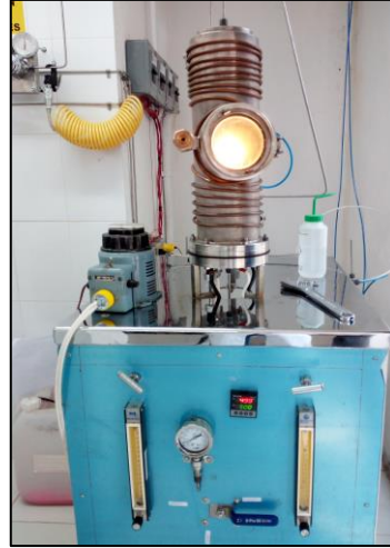
Figura 3.5.- Imagen real del sistema de depósito HWCVD usado para la obtención de películas delgadas de SiOC:Eu.
