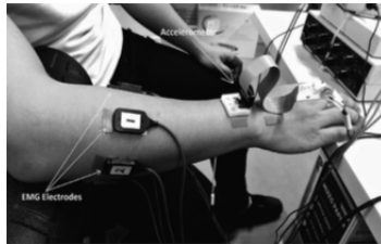
Figura 17: Configuración de los electrodos EMG [23].
