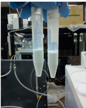
Figura 3.12: Fotografía de una muestra de esferas recién centrifugada, la parte en blanco son las esferas separadas del agua.
