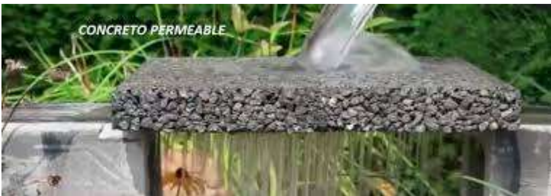
Figura 25.- Filtración del concreto permeable
