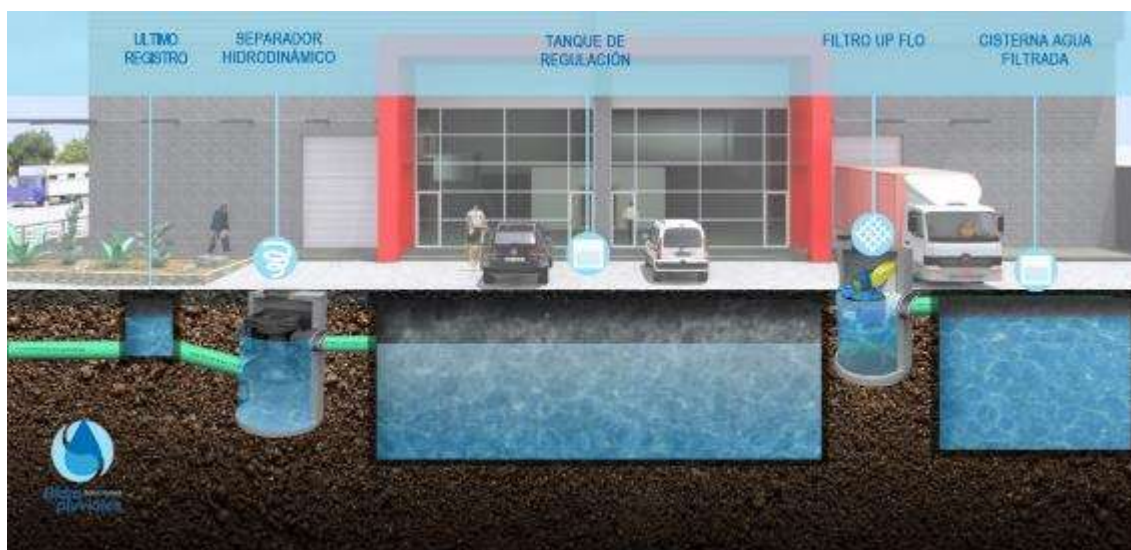
Figura 5.- Esquema del Tren de captación pluvial
