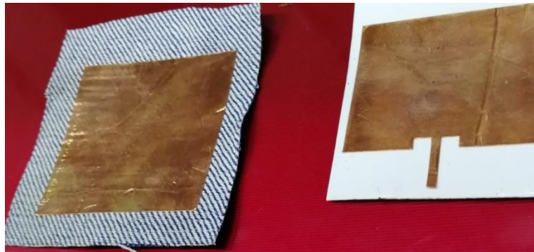
Fig. 4.4 Plano de tierra colocado sobre el sustrato (izq), parche aún en su hoja de cinta (der)
