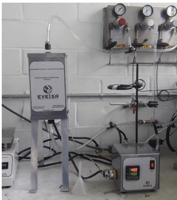
Figura 2.5 Sistema de Reacción para la Reducción de Plata usando H_2
