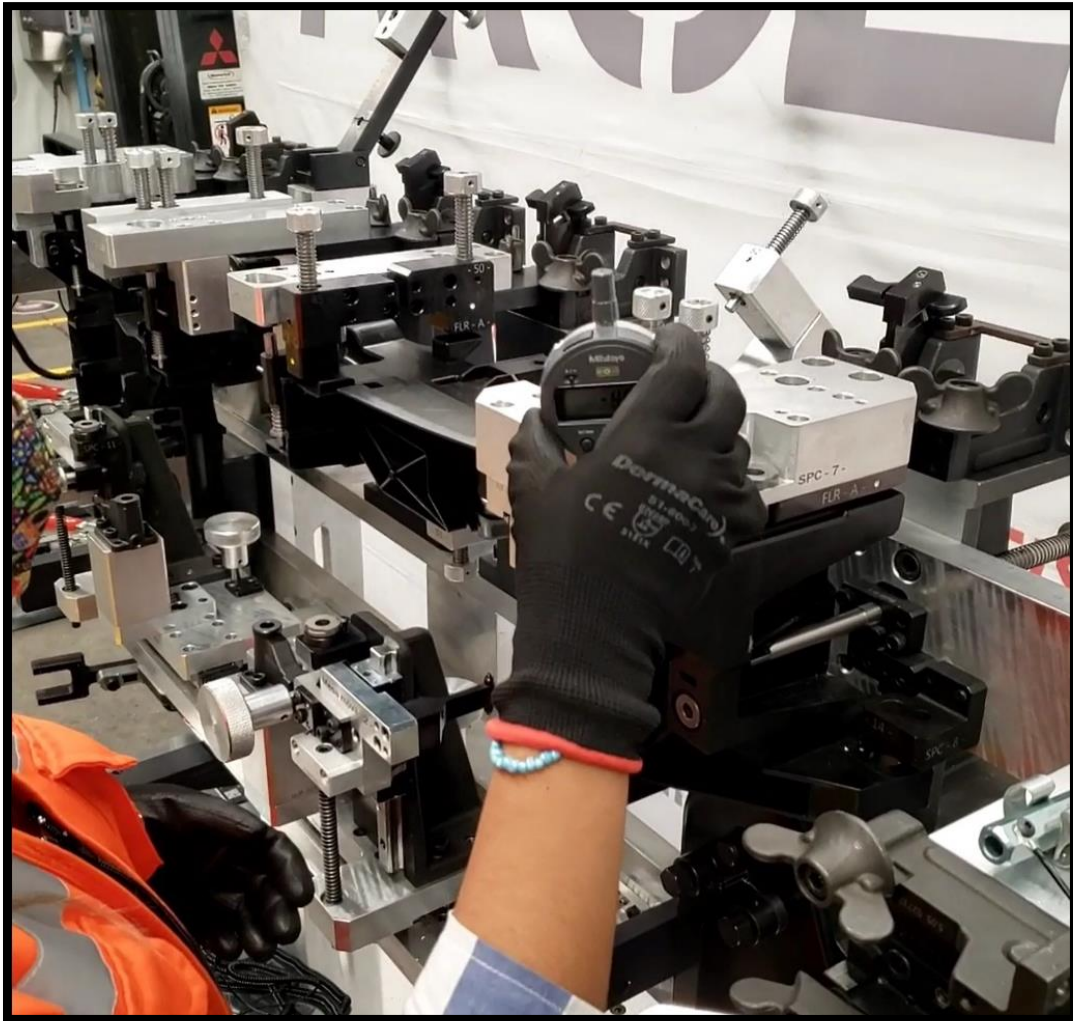
FIGURA 5.1 VERIFICACIÓN POR VARIABLES PARA ESTUDIO GR&R.
