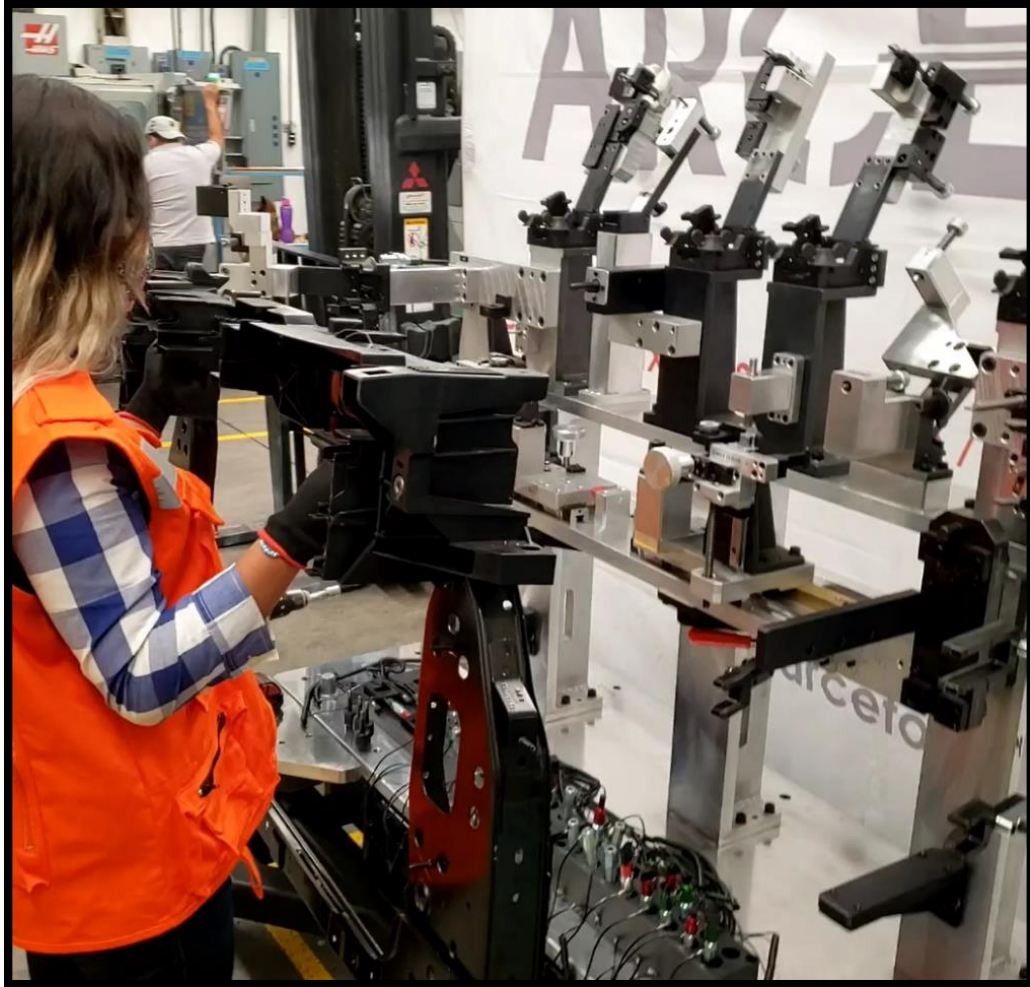
FIGURA 4.15 MONTAJE DE LA PIEZA EN EL DISPOSITIVO.
