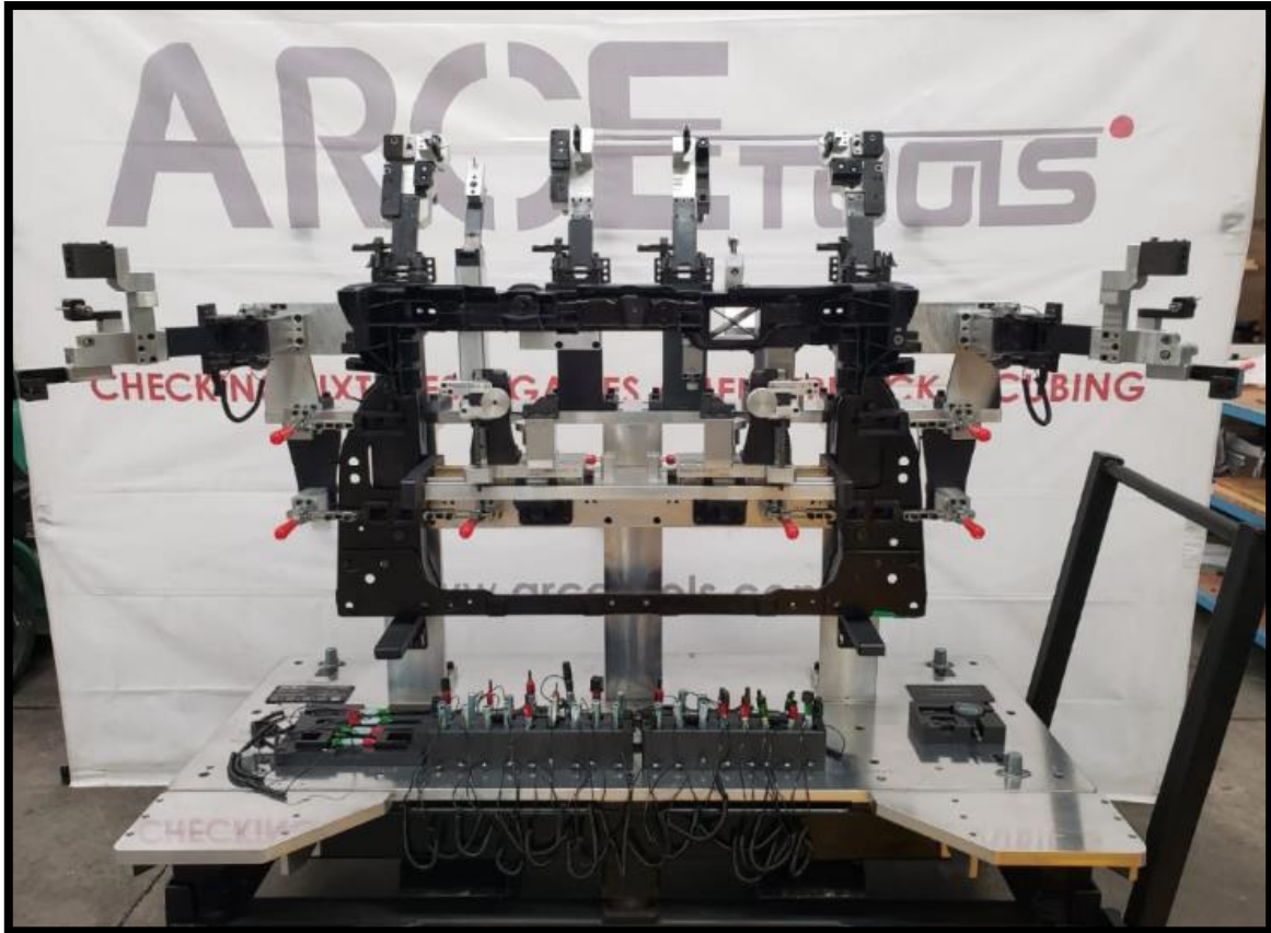
FIGURA 4.11 DISPOSITIVO FUNCIONANDO CON LA PIEZA EN CONDICIÓN DE ENSAMBLE.
