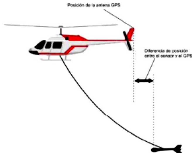
Figura 2.8 Diagrama que representa el error causado por la diferencia entre la posición del GPS y el sensor (Celestino Olivares, 2019).
