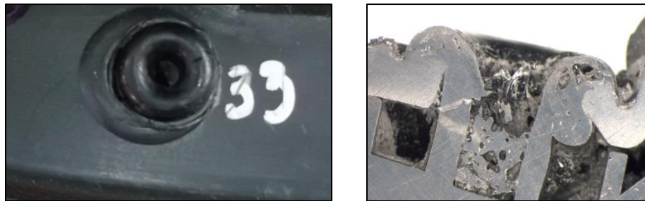
Fig. 24 Soldadura circular de ABS + PPT y corte transversal de la misma soldadura.
