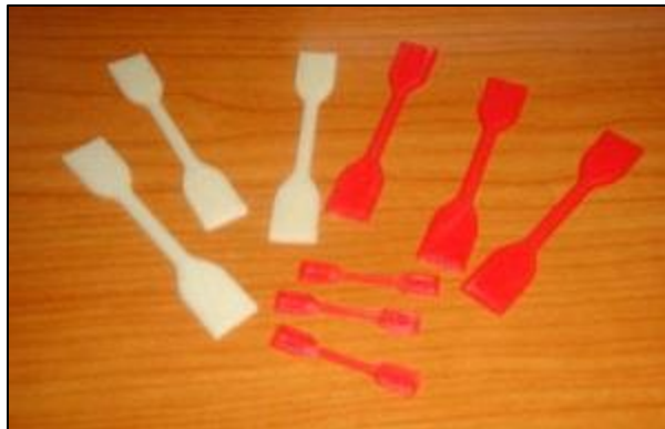
Fig. 9 Geometría de las probetas para la prueba de tensión.
