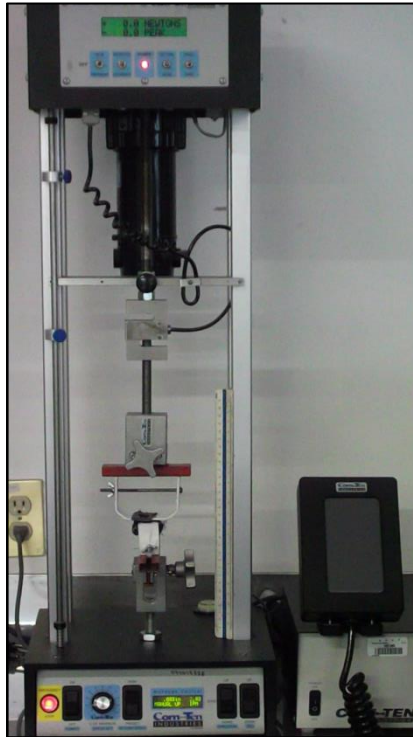
Fig. 8 Máquina Universal de tensión/compresión.
