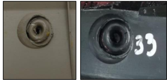
Fig. 11 Piezas plásticas soldadas ubicadas de revestimiento de automóvil.
