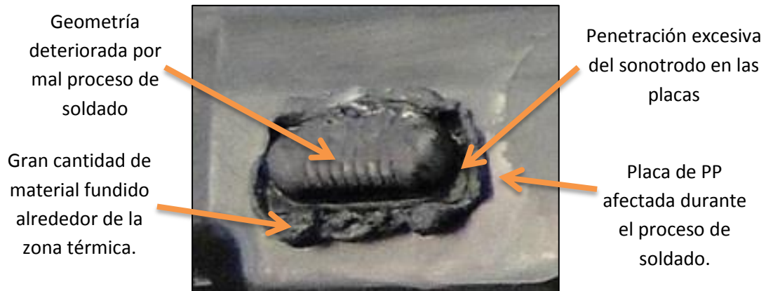
Fig. 30 Soldadura lineal con menor fuerza de desprendimiento.
