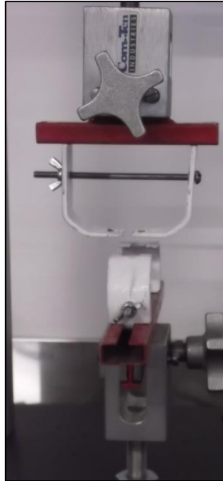
Fig. 22 Montaje de mordazas.
