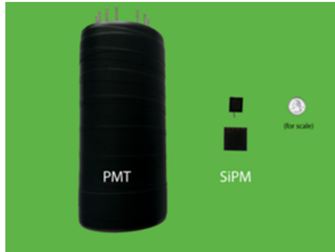
Figura 3.5: A la izquierda hay un instrumento PMT; en medio hay un detector de radiación SiPM; a la derecha una moneda [63].
