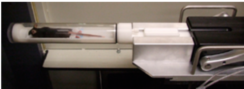
Figura 2.13: El ratón se coloca en un tubo diseñado para facilitar la anestesia y la consistencia de posicionamiento. (Fotografía de David B. Stout [11]).
