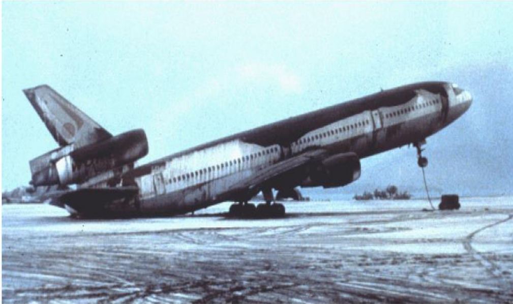
Figura 4.2 Airways DC-10 en la Estación Aérea Naval Cubi Point, a 40 km del Monte Pinatubo, inclinado hacia atrás con ceniza volcánica en el estabilizador, lo que parece ser nieve, es en realidad ceniza volcánica en el suelo; estas partículas grandes producen efectos locales devastadores y efectos meteorológicos a corto plazo.
