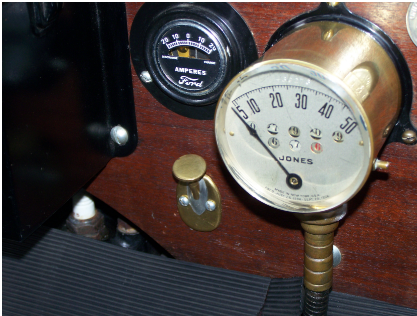
(a) Velocímetro y amperímetro del año 1914. Fuente : https://es.wikipedia.org/wiki/Ford_T .
