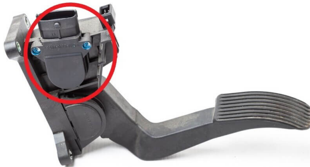
Figura 3.8: Sensor de posición del pedal de aceleración (APP). Fuente: [38]
