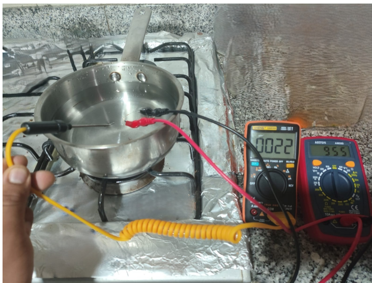
Figura 4.27: Configuración experimental para la calibración del nodo de temperatura con termistor NTC, multímetro y termopar.
