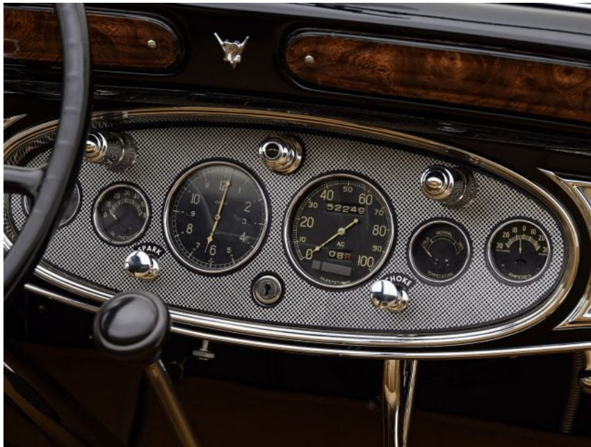
Figura 1.2: Cuadro de instrumentos de un cadillac v12 convertible del año 1931. Fuente : https://hymanltd.com/vehicles/5914-1931-cadillac-v12-convertible-coupe/ .
