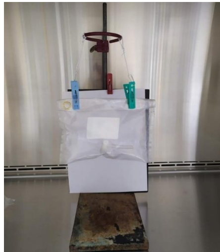
Figura 23. Colocación de la bolsa de biogás dentro de la campana de flujo laminar para la medición con el LMM.
