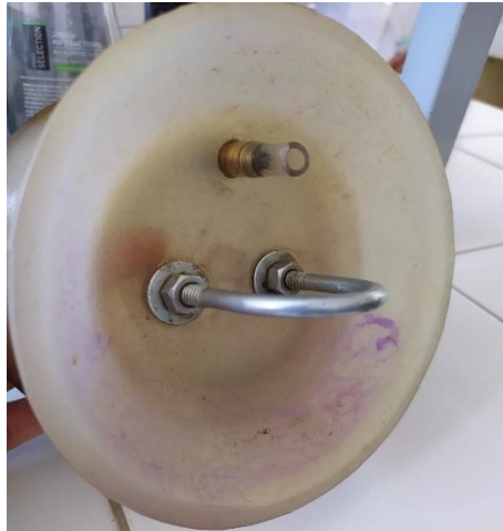
Figura 18. Preparación de los tapones de las cánulas para la extracción de gas entérico.
