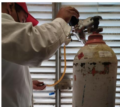
Figura 10. Llenado de bolsas de biogás con CH 4 .
