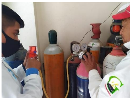
Figura 7. Llenado de trampa de sal con CH 4 .
