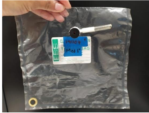
Figura 19. Preparación de las bolsas de biogás para el llenado con gas extraído del rumen en vacas con cánula ruminal.
