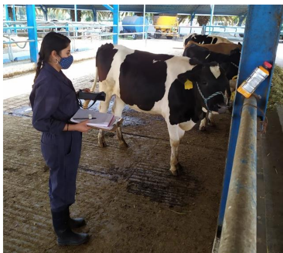
Figura 15. Posición del equipo LMm para medir las concentraciones de metano del flanco derecho de las vacas secas canuladas.
