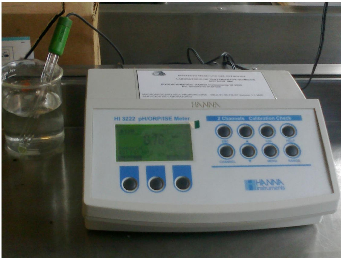
POTENCIÓMETRO HANNA HI 3222 UTILIZADO PARA LA MEDICIÓN DEL VALOR DE pH DE LAS MUESTRAS DE AGUA
