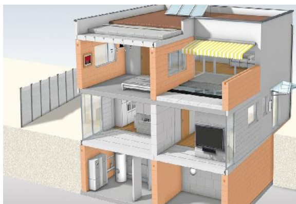
Figura 2.6 Construcción de una vivienda residencial con block celular y panel losa celular.
