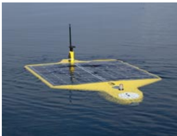
Figura 1.3: Mini-Submarino Tipo AUV, este vehículos submarino autónomo (AUV) funciona con energía solar. La cantidad de potencia disponible y el peso de la fuente de alimentación son factores importantes para los diseñadores AUV y usuarios. Imagen cortesía de AUVfest 2008 [7].
