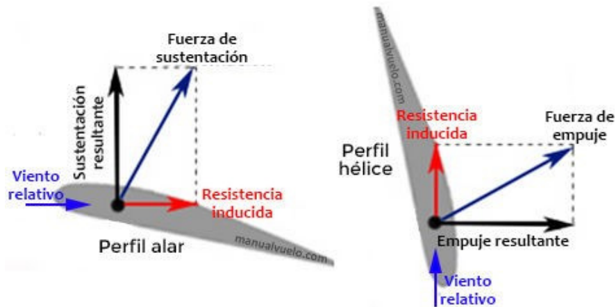
Figura 1.17: a) Efectos del viento sobre un elemento de aspa (pala) [17]
