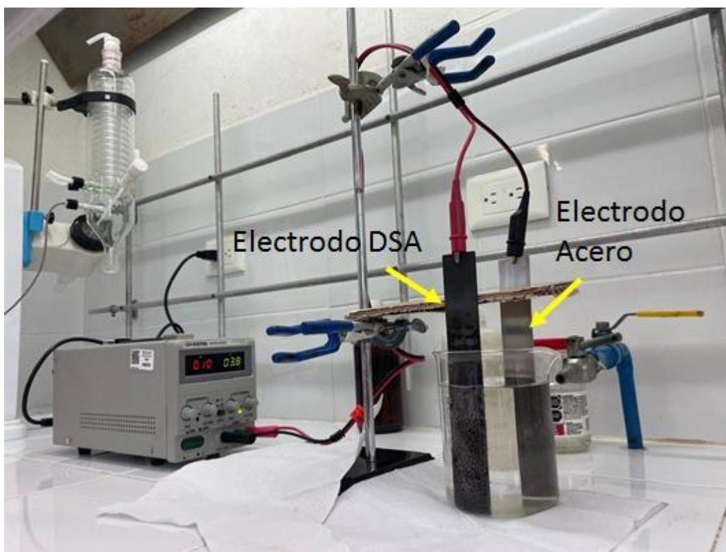
Figura 10. Activación electroquímica del electrodo DSA (ánodo) en una disolución de \text{H}_2\text{SO}_4 0.5 M, aplicada mediante una corriente constante de 0.1 A durante 20 min. El cátodo es un electrodo de acero inoxidable.
