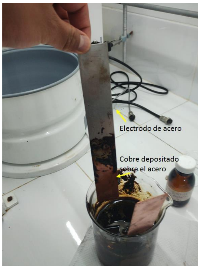
Figura 28. Depósito de cobre sobre el cátodo de acero observado tras la electrólisis del combustóleo empleando la combinación de electrodos Cu (+) / Acero (-), evidenciando la inestabilidad de esta configuración durante el proceso.
