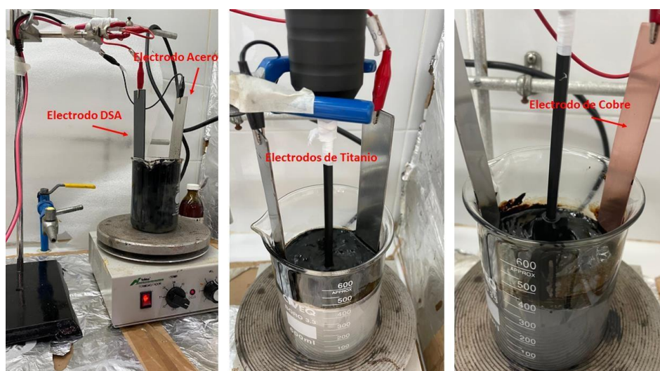
Figura 24. Imágenes de los materiales de electrodos utilizados durante las electrólisis: DSA, titanio, cobre y acero. Estas fotografías permiten visualizar las superficies de contacto y la geometría de los electrodos empleados en los diferentes ensayos de electrodesulfuración.
