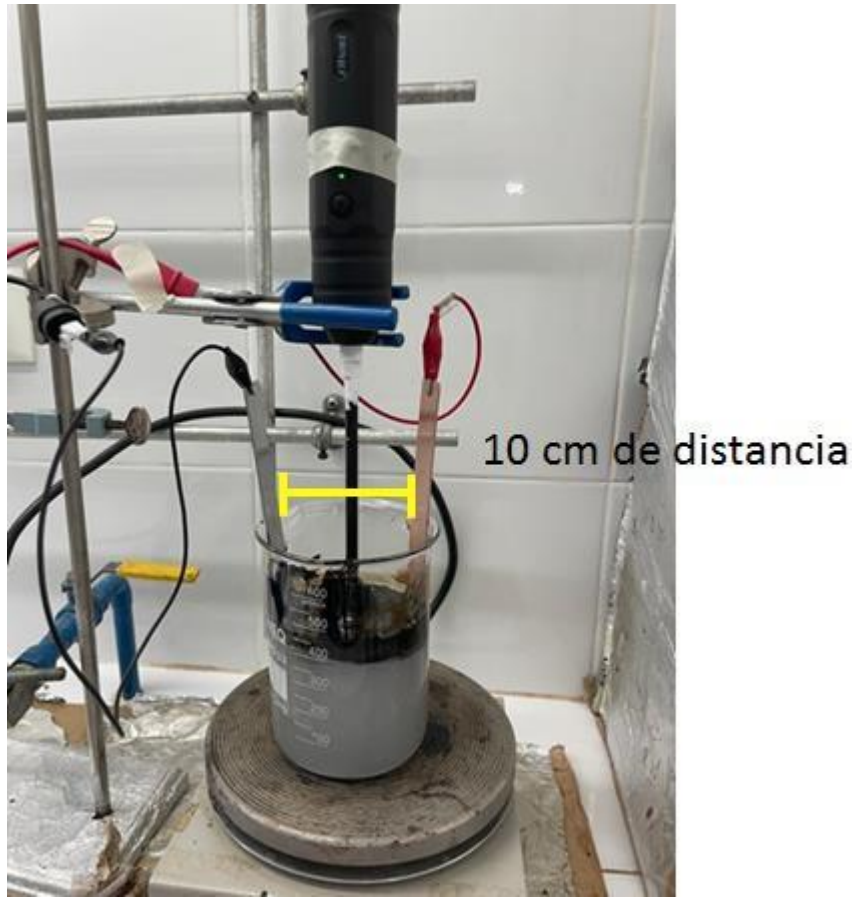
Figura 6. Sistema electroquímico empleado para la electrodesulfuración, con los electrodos sumergidos en una disolución de NaOH 0.7 M en contacto con el combustóleo. El montaje se encuentra colocado sobre una parrilla de calentamiento con agitación incorporada, operando en el rango de 60–80 °C para favorecer la homogenización y el proceso electroquímico. Electrodo empleado en la electrólisis: Cu (+) / Acero (-).
